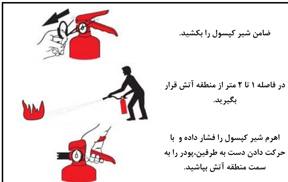
شکل ۱- برچسب اطلاعات مربوط به نحوه استفاده از کپسول آتش نشانی (بطور مثال)
